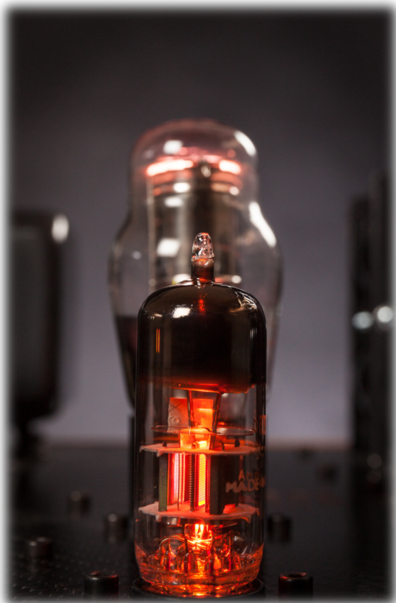
Pentodo D3A ad alta transconduttanza
