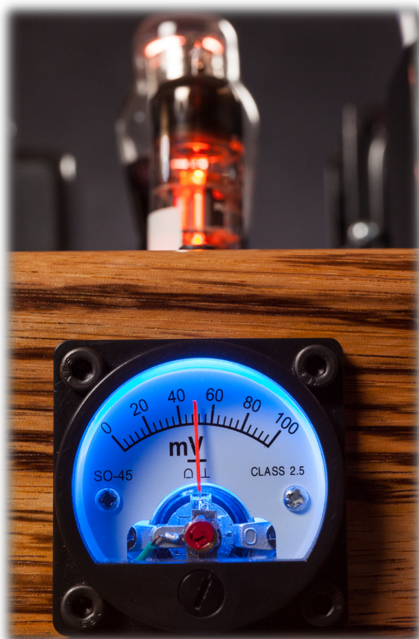
mVoltmetro che monitora la corrente di riposo delle 2 A 3
